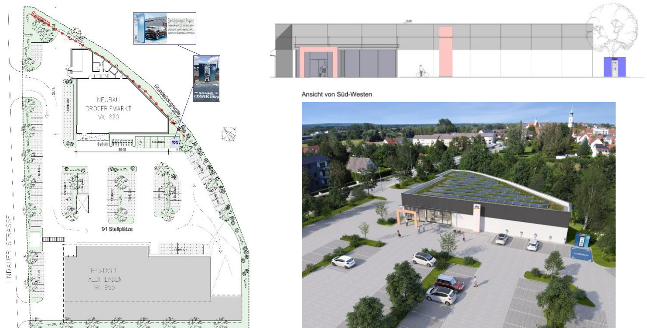
Abb. 4: Lageplan (links), Schnitt (rechts oben) sowie Visualisierung (rechts unten) des geplanten Drogeriemarktes (Quelle: Damek Architekten Partnerschaft mbB mit Genehmigung von Aldi SE& CO. KG)
